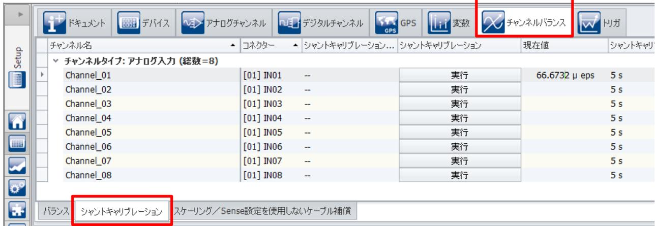
[実行]をクリックしてシャントキャリブレーションを実行します。シャントキャリブレーションを行う際に、ブリッジはシャント（並列に接続された抵抗）によって、特定時間アンバランスになります。利用可能なシャントは使用するアンプのタイプに依存します。シャントキャリブレーションは測定中であっても実施することができます。実行時間を最小時間に設定した場合でもシステムの負荷状態に依存してシャントキャリブレーションの実行時間は長くなります。
