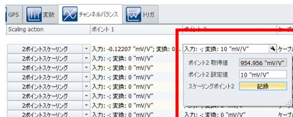
項目「Scaling action」にて、[2ポイントスケールリング]を選択、クリックします。
