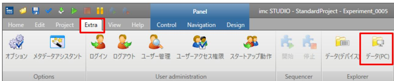
“データ(PC)”をクリックすると、下記の通り、測定データが保存されているデータベースフォルダが開かれます(フォルダ構造は設定による)。これらのデータは、imc FAMOS により表示・後処理解析をしていくことができます。
