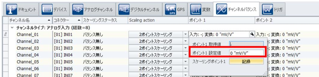
「記録」ボタンをクリックすると測定が開始します。測定が完了すると、「ポイント1 取得値」に測定結果が表示されます。
