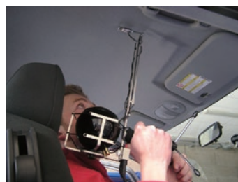
インピーダンスガンによる計測
