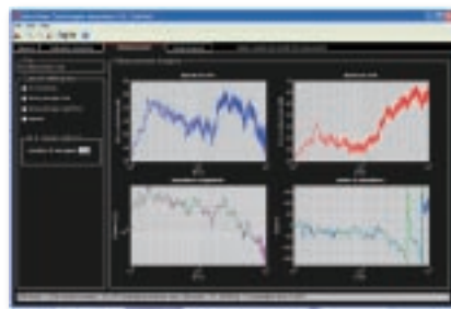
計測した音響粒子速度と音圧データから表面インピーダンスを計算
