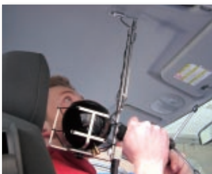
インピーダンスガンを用いて、サンプル表面の音響粒子速度と音圧を計測
