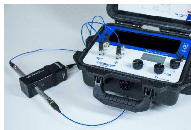
例2：音響校正器(型式:9917C)を駆動する場合
