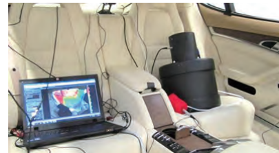
リファレンス位置へのモノポール音源の設置
