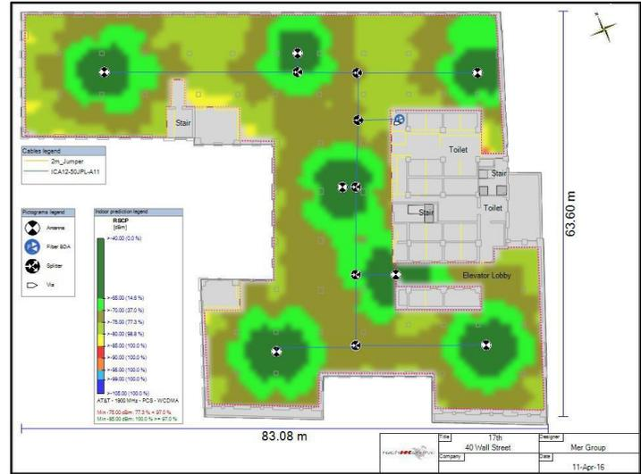
iBwave Designによる精緻な電波伝搬シミュレーションにより、ネットワーク設計の正確性が確保され、過剰な設備投資を回避し、手直し工数を削減します。
