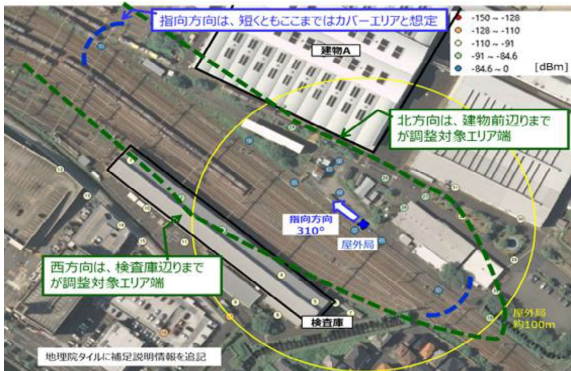
図 5.4.3-6 屋外基地局周辺の受信電力値から推定したエリア図
