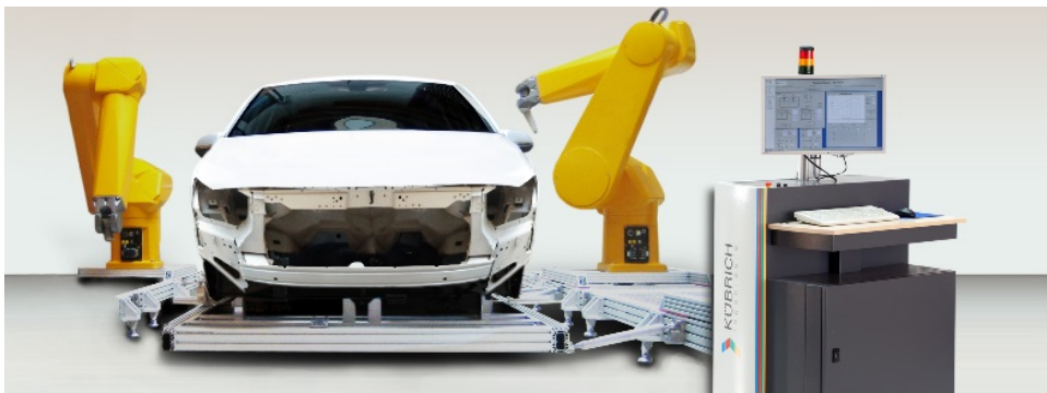
自動車ドア開閉耐久試験ロボットシステム「ROACTERE」
