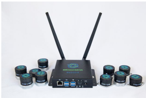
Broadsens ワイヤレスセンサー(中央は専用のワイヤレスゲートウェイ)
