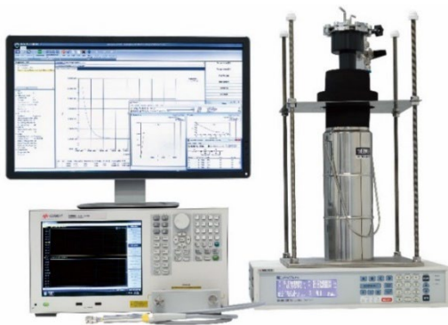
高周波インピーダンス測定システム
