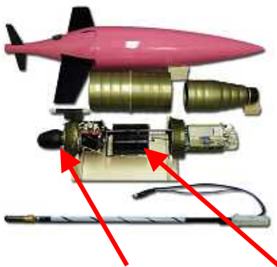
浮力調整体(ブラダー) バランサー(バッテリー)
