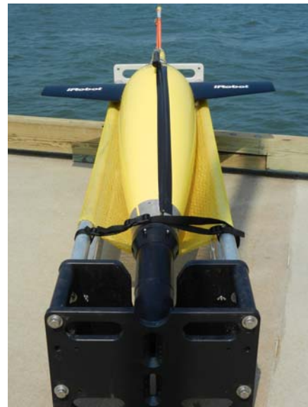
標準進水クレードルに載せられた放射線センサ搭載 Seaglider™
